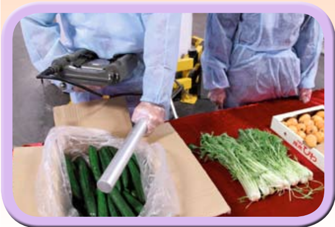
中心人員用手提測量計量度日本進口 食物的輻射水平
