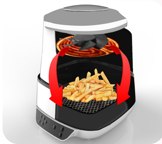
圖2: 空氣炸鍋的基本原理-發熱元件旁設有風扇, 帶動熱空氣迅速循環。食物接近熱源, 滴下的油收集在網籃下方。
